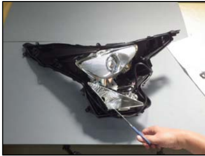
ガスケットをカット
