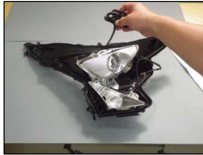
ガスケット取り外し
