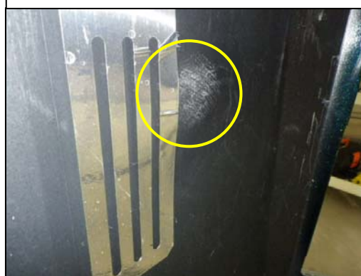
局部変形状態(バンパー裏面)
