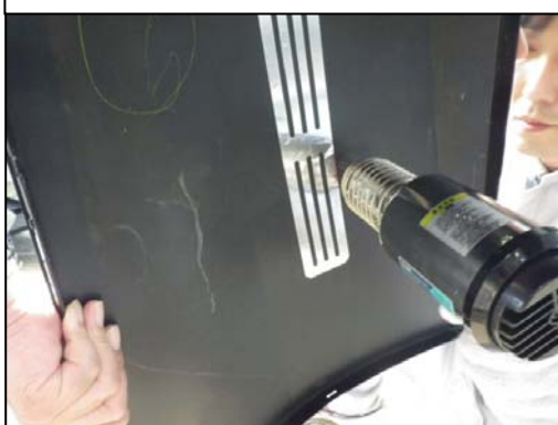
工業用ドライヤーで加熱
