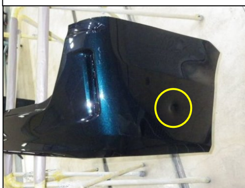
局部変形状態(バンパー表面)
